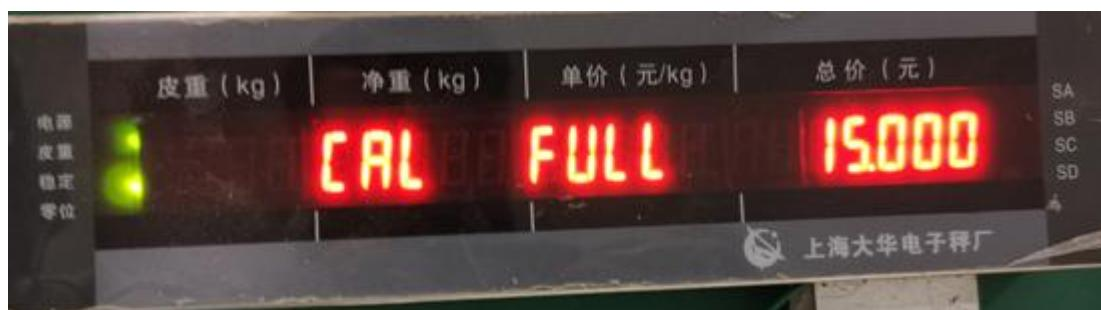
按【确认】键，输入秤的过载量 ( 15kg 输入 45 ； 30kg 按 90 , 过载量为分度值的九倍 )
