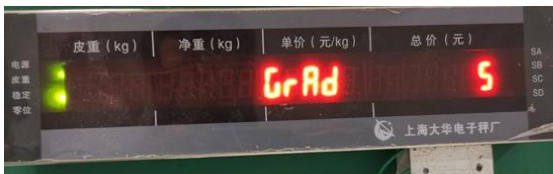
按【确认】键，输入秤的满量程 ( 15kg 输入 15000 ； 30kg 按 30000 )
