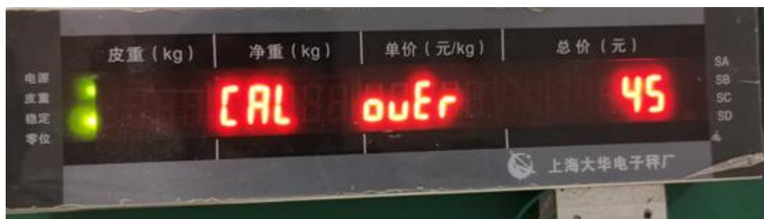
按【确认】键，输入秤的加载量 5kg ( 15kg 输入 5000 ； 30kg 输入 10000. 加载量至少为满量程的 1/3 )
